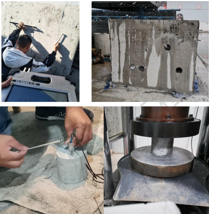
强度模型测试、取芯、芯样测试、芯样压载
