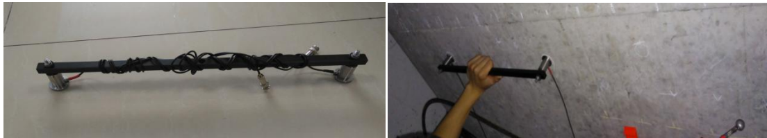
图 4-2-9 混凝土强度测试支架及使用情形
