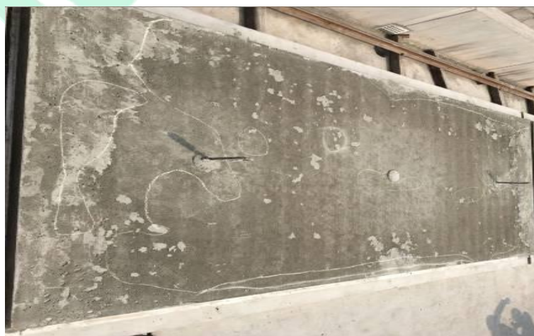
图 3-1-16 上：小里程板测试脱空等值线图，
