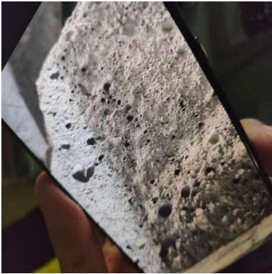
图 3-2-6 CRTS III 型无砟轨道板自密实混凝土检测结果图
